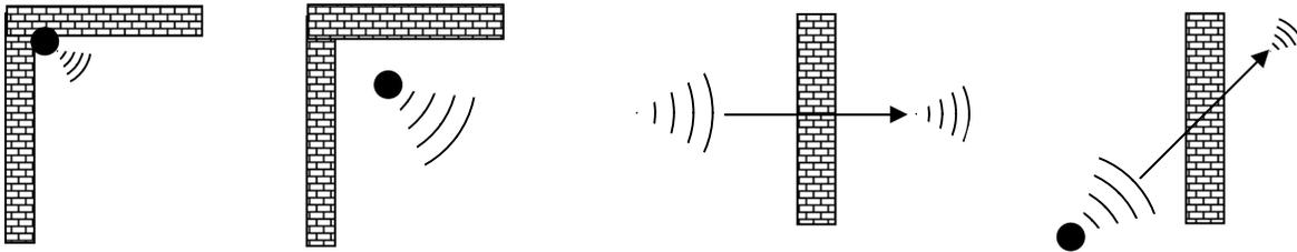
Das Signal kann durch Wände aus Vollmetall nicht hinausgelangen. Andererseits kann das Signal eine Metallverstrebe Wand unter Einschränkungen durchdringen.
