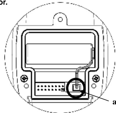
Lösen sie den Batteriestecker
