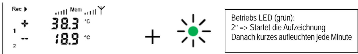
Das Display zeigt die Temperatur in Grad °C, Kanal Nummer, Messeinheit und Speicher Status.
