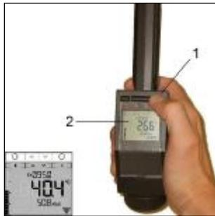
(Werksvoreinstellung) bzw. **On** eingestellt ist, hat die **I**-Taste in diesem Fall automatisch die Funktion der **Messtaste** [1] und die Anzeigen im Display [2] sind um 180° gedreht [**► Flip-Display**].
