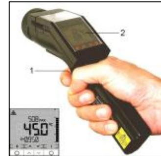
Das Gerät kann auch in vertikaler Lage (Messung nach unten) benutzt werden. Bei dieser Handhabung lassen sich z.B. kleine SMD-Bauelemente auf Elektronik-platinen leichter anvisieren und somit exakt messen. Halten Sie das Gerät dazu wie in der linken Abbildung gezeigt. Wenn die Displayumschaltung auf **Auto**
