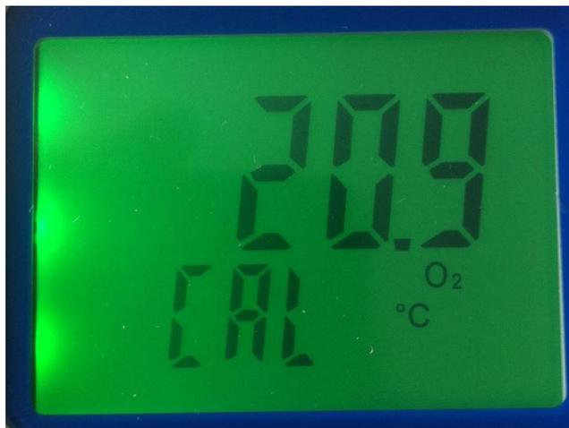
4. Drücken Sie jetzt die Taste ENTER. Die Displayanzeige zählt jetzt von 30 Rückwärts bis auf 0 herunter und wechselt dann in den normalen Messmodus und beendet somit den Kalibrierungsvorgang. Durch erneutes Drücken der Taste „FUNCTION“ erhalten Sie wieder eine Anzeige der mg/L.
