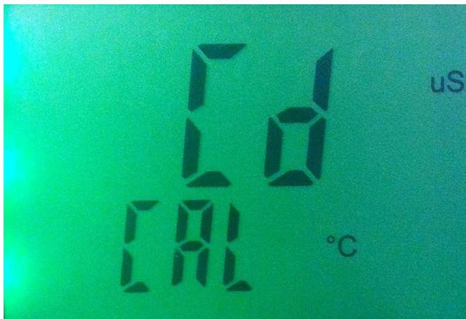
6. Drücken Sie nun die Enter Taste, der Wert erscheint jetzt in der oberen und unteren Displayanzeige. Nutzen Sie die Pfeil oben oder Pfeil unten Taste um den oberen Displaywert exakt dem der Lösung anzupassen.
