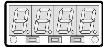
Der Zustand der Relais wird mit Hilfe der 2 LED's unterhalb der 7-Segmentanzeige angezeigt, wobei die linke LED den Zustand von Relais 1 und die rechte LED von Relais 2 anzeigt.
