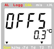
'Offset T2': Nullpunktverschiebung der Temperatur T2
