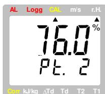
Stecken Sie die Sonde in die entsprechend vorbereitete Kalibriervorrichtung mit dem zweiten Feuchtwert.
