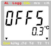
'Offset T1': Nullpunktverschiebung der Kombifühler-temperatur T1 (nur bei TFS0100)
